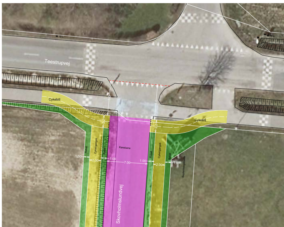
Ombygning af cykelsti langs Teestrupvej med vigepligt for cyklister og enkeltrettede fællestier langs Skovholmslundvej.
